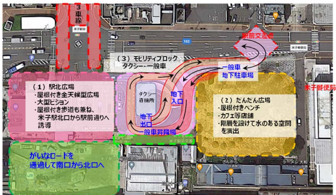
図-11 タクシー乗り場及び一般車両の進入路の配置イメージ
